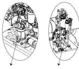
Perkins: fuel/water separator Deutz: fuel/water separator
